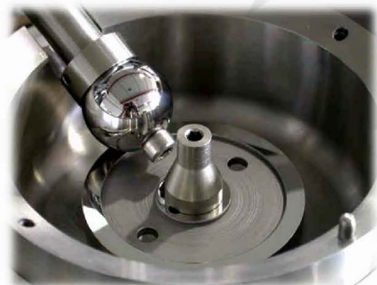
Испытательный стенд для проведения испытания для расчёта срока службы по схеме «шарик по плоскости»
